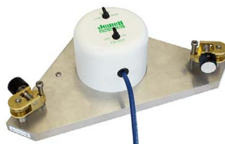
Per livellare gli assi X e Y del Tiltmetro a piattaforma geodetica modello A603, l'utente ruota una manopola che solleva o abbassa una vite invar mediante un gruppo di ingranaggi a vite senza fine.
